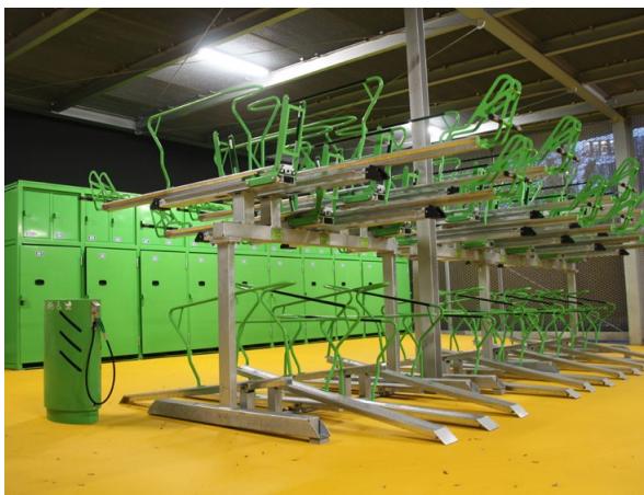
Fahradparkhaus mit platzeffizientem Doppelstockparksystem, Luftpumpe und abschließbaren Boxen
